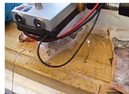
Fig. 11: Fjerning med fryseelement
